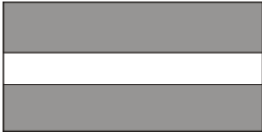
1.2 Обозначение края проезжей части дороги (может иметь желтый цвет)
